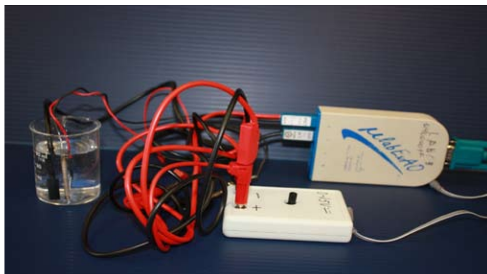
Figure 2. Prototype de la transformation de l'énergie électrique en énergie thermique.
